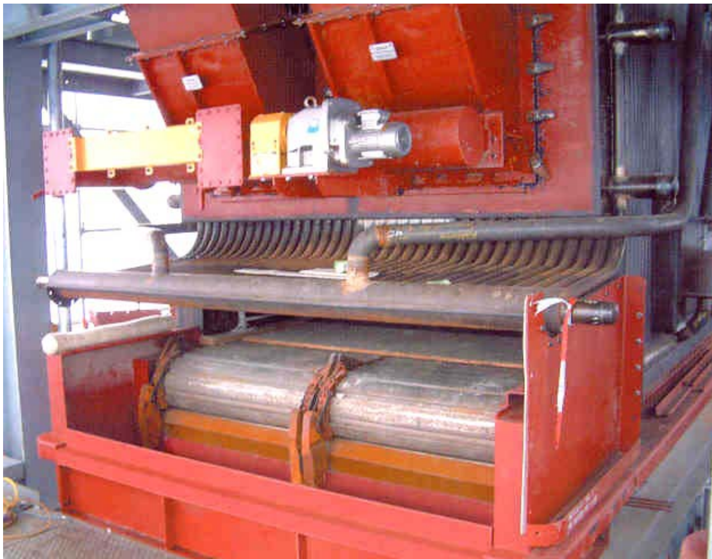
Biomass traveling- grate spreader stoker (Siemens)
