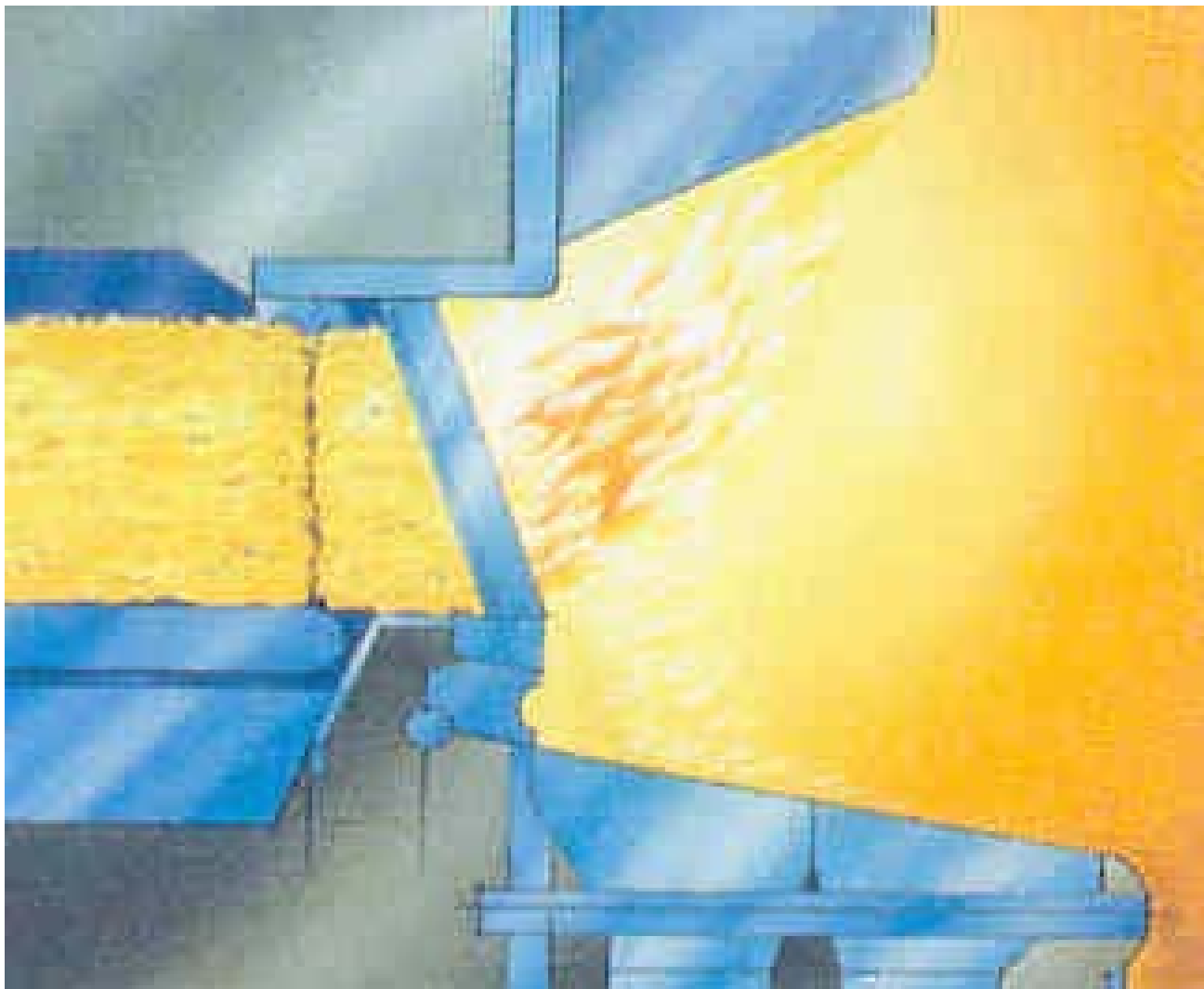
Esquema de una caldera de combustión de biomasa “cigar-fire”
