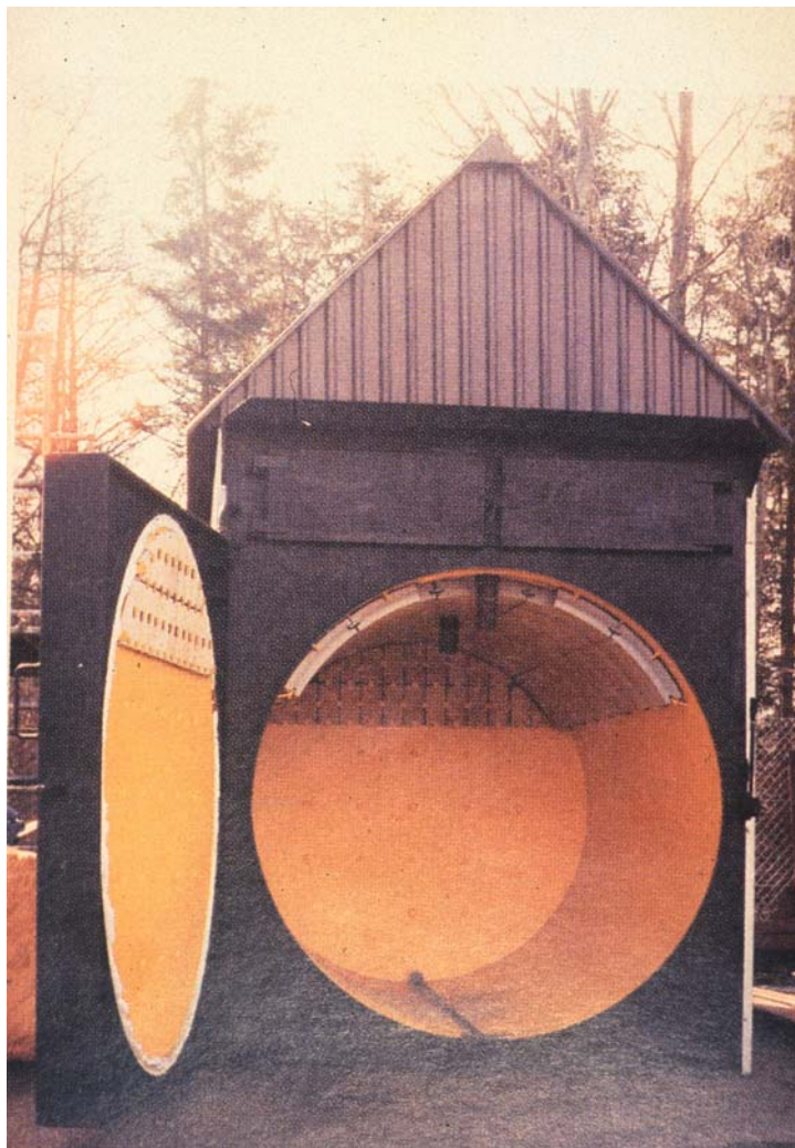
Caldera para balas redondas de paja. 150kWt
