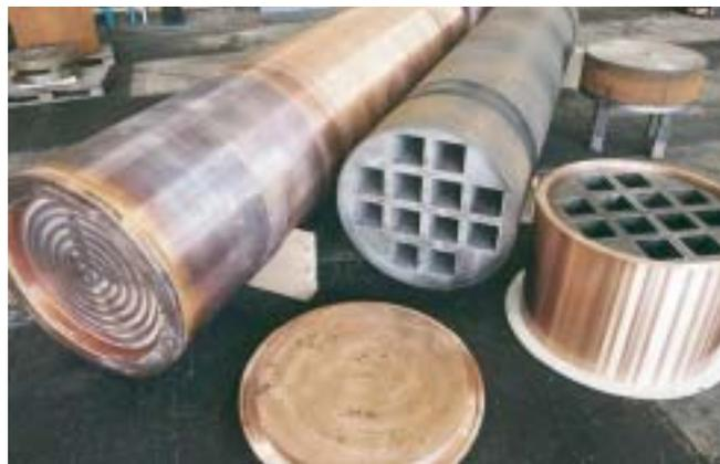
Figura 5.27. Cápsula de almacenamiento para 12 elementos tipo BWR. Parte interior: fundición nodular. Camisa exterior: cobre. Fuente SKB.
