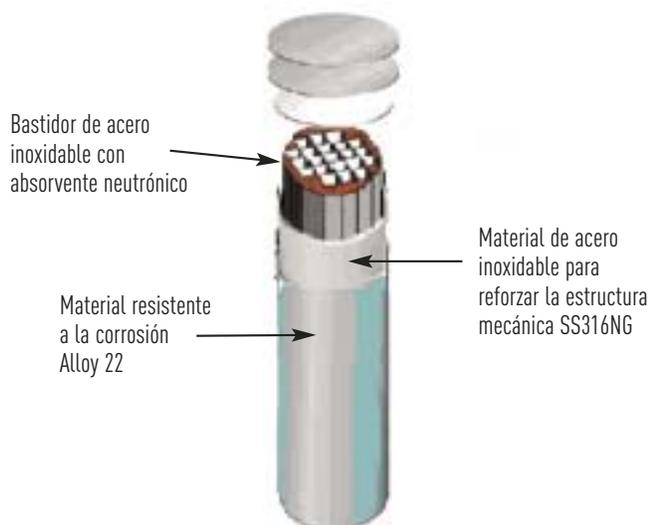
Figura 5.28. Cápsula de almacenamiento – 21 PWR. Fuente DOE.
