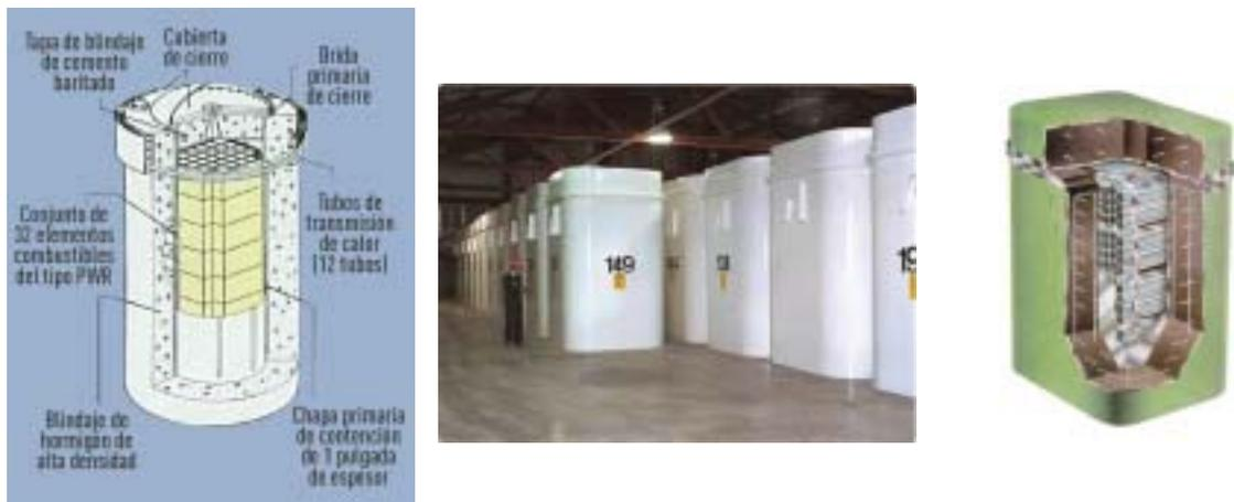
Figura 5.11. Ejemplos de contenedores de hormigón para almacenamiento temporal del combustible gastado.
