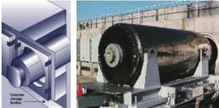
Figura 5.14. Almacenamiento temporal en silos de hormigón.
