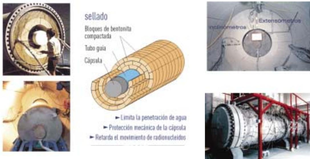
Figura 5.33. Materiales de relleno y sellado. Diseño conceptual y ensayos realizados, a escala real, en maqueta (Ciemat) e *in situ* (Laboratorio subterráneo de Grimsel, Suiza) para estudiar su comportamiento termo-hidro-mecánico.
