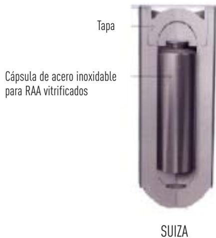
Figura 5.30. Cápsula de almacenamiento de residuos de alta actividad vitrificados. Fuente NAGRA.
